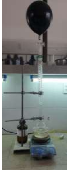
Hình 2.1. Bong bóng được lắp vào hệ điều chế nano vàng
