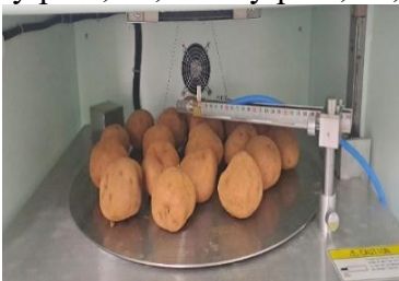
Hình 2.5. Bố trí khoai tây và dâu tây để chiếu xạ tia X
